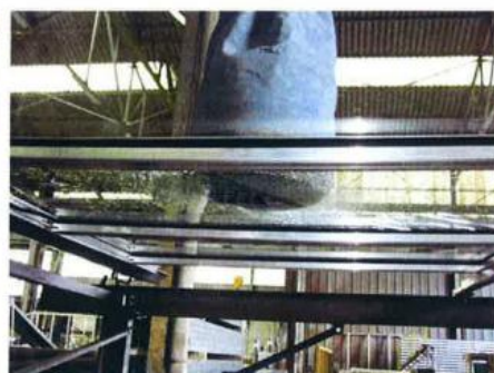
Essai 1200 joules : chute d'un sac de 50 kg d'une hauteur de 2.40 m
