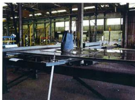
Essai 1200 joules : chute d'un sac de 50 kg d'une hauteur de 2.40 m
