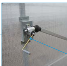
Aération latérale par enroulement
